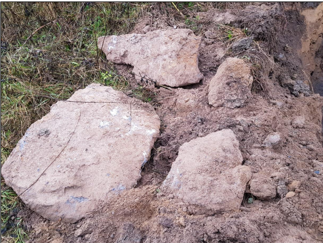
Kuva 2. Koekuopassa SE4 havaittuja betonikappaleita.
